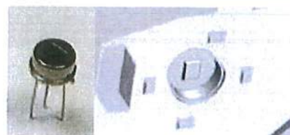
Capteur d'activité humaine Détecte les mouvements humains, les changements dans les niveaux d'activité et l'absence de l'homme.
